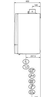
Abmessungen, Platzbedarf und Anschlusspunkte
